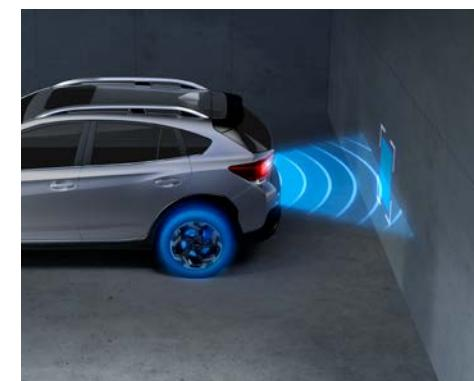
Automatisk bremse ved bakning (RAB)\*<sup>1</sup>\*<sup>2</sup>
